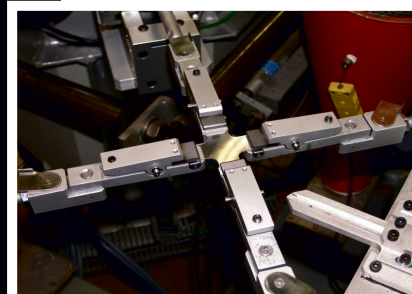
Ci-dessous, l'étirage bi-axial d'une plaque de PET recyclé.
